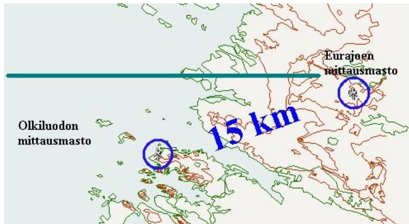
Kuva 1. Olkiluodon ja Eurajoen mastot. Olkiluodossa mitattiin 20, 60 ja 100 m korkeudella ja Eurajoella 75 ja 95 m korkeudella. Vaakaviiva edustaa kuva 4:n tuottolaskelmassa käytettyä linjaa.
