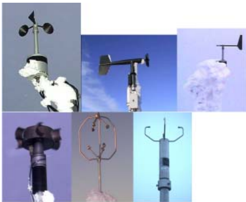
Kuva 1. a) Vaisala Oyj:n lämmitetyin kupein varustettu tuulen nopeuden mittari, b) Young'in lämmitettämätön yhdistetty nopeus- ja suunta-anturi, c) Vaisalan lämmitetty suunta-anturi, d) Hydro-Tech'in jäätymätön nopeusanturi, e) Metek'in 3D akustinen mittari ja f) Thies'in 2D akustinen mittari. (Tammelin et al., 2004. Ilmatieteen laitos).
