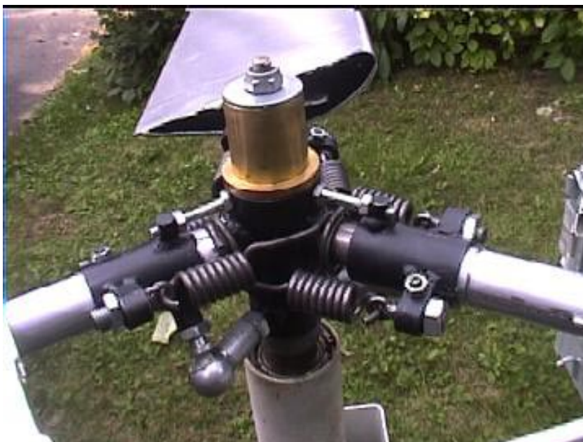
Kuva 2. Jousilla esikuormitettu, keskipakovoimalla toimiva lapakulman sää- tömekanismi rajoittaa tehoa, kun pyörimisnopeus vastaa maksimitehoa.
