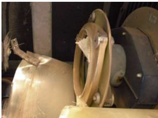
Voimansiirtokytkimen rikkoutuminen, josta seurasi isoja mekaanisia vauriota koneistolle (pieni alkuvahinko, mutta suuret seuraukset)
